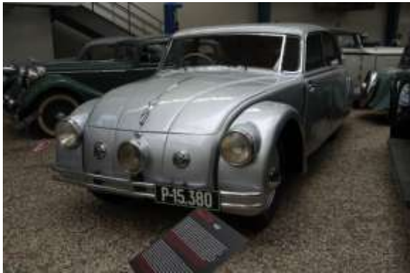
リアの流線デザインと3灯ヘッドランプが特徴的な 1937年式 タトラ 77a (チェコ)
