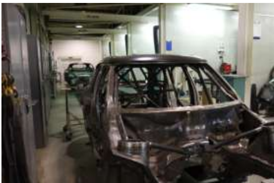
ボディワークセクションでは自動車メーカーから提供されたホワイトボディにロールゲージやスポット増しといった補強加工が施される
